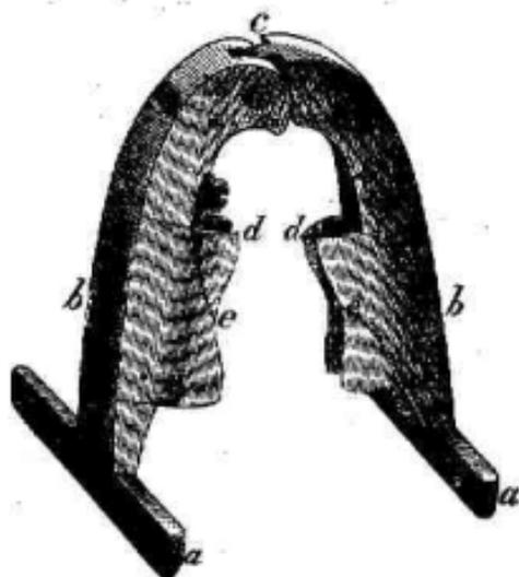
Hobeleisen (Stahlfedern), welche zugleich mit dem Schnitte die Rinde von der Rebe in der Breite von 1 Linie entfernt. bb Die Oeffnungen, durch welche die durch das Hobelcisen abgeschälte Rinde hinausfällt.
