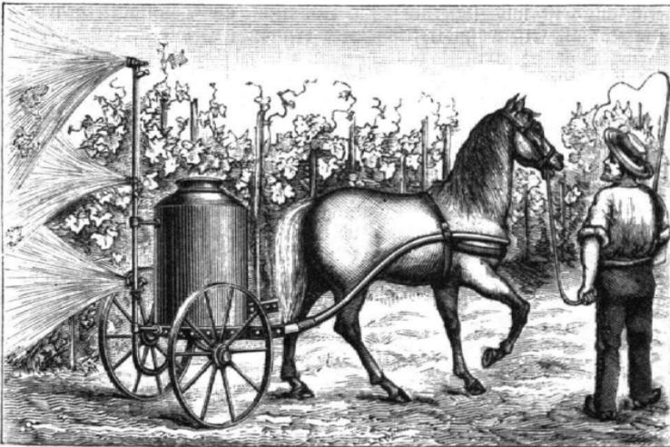
Fig. 3. Pulverisator Nr. 2 bis mit vertikaletm Ausflußrohr für Pfahlanlagen.
