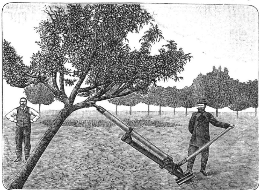
Fig. 2. Die Aufrichtemaschine an einem schiefen Baum.
